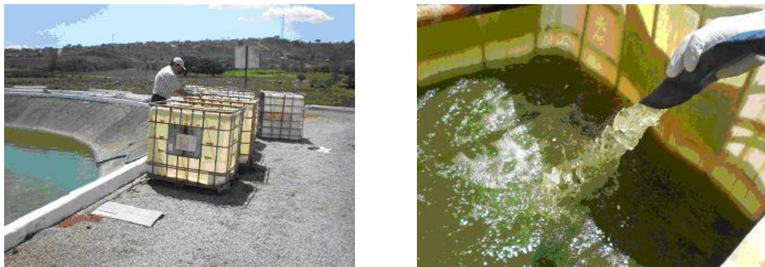
Figura 2: Montagem dos contêineres à margem da lagoa de estabilização da ETE Matozinhos e o enchimento dos mesmos com a amostra de efluente.
